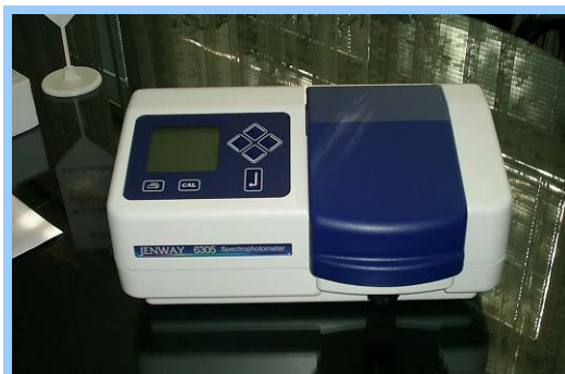
Спектрофотометар со кој се врши проверка на исправноста на производите
